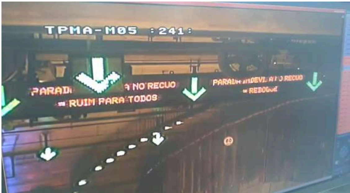
Figura 12: Imagem de um dos Painéis de Mensagens Variáveis (PMVs), obtida através de um monitor no CCO, exibindo um par de mensagens
